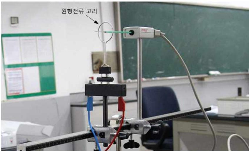
그림 3.4 원형전류고리에 의한 자기장 측정
